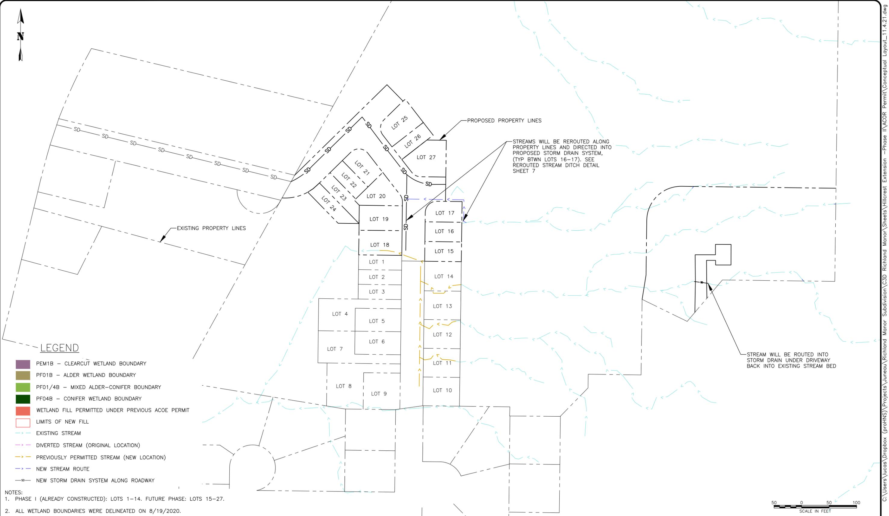
STREAMS WILL BE REROUTED ALONG PROPERTY LINES AND DIRECTED INTO PROPOSED STORM DRAIN SYSTEM, (TYP BTWN LOTS 16-17). SEE REROUTED STREAM DITCH DETAIL SHEET 7
